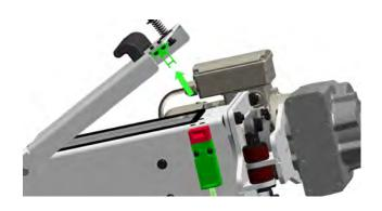
Dieser Sicherheitsschalter gewährleistet, dass beim Öffnen der Austragungskanal-Abdeckung die Stromzufuhr zum Förderschneckenmotor unterbrochen wird.
