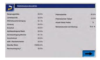
In diesem Menü werden die Betriebsstunden der einzelnen Ausgänge aufgelistet. Diese werden nur dann gezählt, wenn der entsprechende Ausgang eingeschaltet ist.
