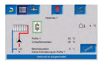
Das App-Symbol zeigt in der Heizkessel-Regelung an, dass der Parameter durch Eingabe an der App geändert wurde:
