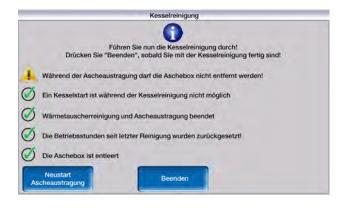
Die Ascheaustragung soll hier neu gestartet werden, damit die im Reinigungsprozess anfallende Asche zur Gänze in die Aschebox transportiert wird. Dies nimmt nur 2 Minuten in Anspruch.
