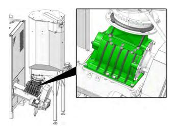
Die Zellradschleuse erfüllt für die zugelassenen Brennstoffe alle normativen Vorgaben betreffend Brandschutz, Rückbrandsicherheit und Rückströmung von Gasen:
