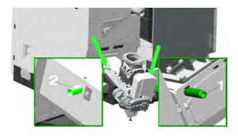
Wird am Temperaturfühler in der Tauchhülse 1 bei Direktaustragung eine Temperatur von 50°C, bei Fallrohraustragung von 95°C überschritten, so öffnet das Ventil und flutet durch das Anschlussrohr 2 den Einschubkanal mit Wasser.
