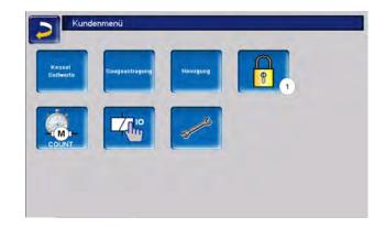
Diese Funktion dient zum Schutz vor unbefugter Änderung der Regelungsparameter. Bei aktiver Benutzersperre werden die Parameter der einzelnen Masken angezeigt, können aber nicht geändert werden.
