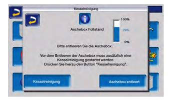
Vor der Entleerung der Aschebox ist im angegebenen Intervall eine Kesselreinigung durchzuführen.
