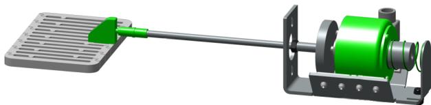
Der Motor überträgt mit dem Gestänge Vibrationen auf den Brennrost. Dadurch wird dieser von Ascherückständen befreit.
