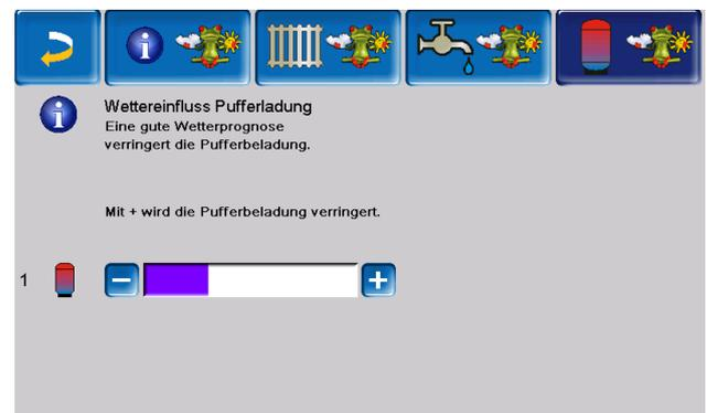
Bei guter Wetterprognose wird der Pufferspeicher innerhalb der Freigabezeit für eine kürzere Zeit beladen.
