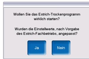
Sobald das Trocknungsprogramm gestartet wurde, wird es je nach eingestelltem Protokoll selbstständig durchlaufen und am Ende ausgeschaltet.
