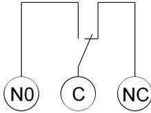
Dies ist ein potenzialfreier Relaisausgang etwa zum Schalten einer optischen oder akustischen Warneinrichtung. Diese löst bei einer Störungsmeldung am Kessel aus.
