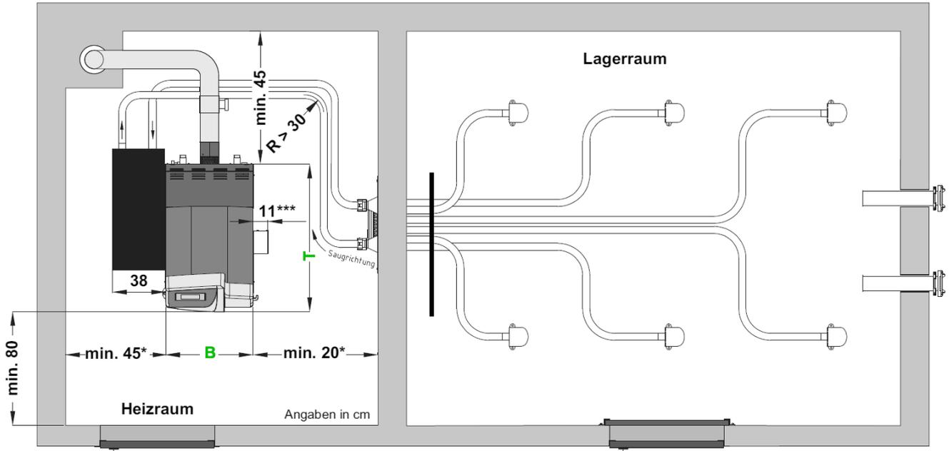
\* Die Zugänglichkeit zur Kesselrückseite muss gegeben sein. Es muss also entweder links oder rechts ein Abstand von mindestens 45 cm gewährleistet sein.
