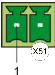
Digitaler Eingang: Der SOLARFOCUS-Heizkessel kann durch eine externe Regelung gestartet werden.
