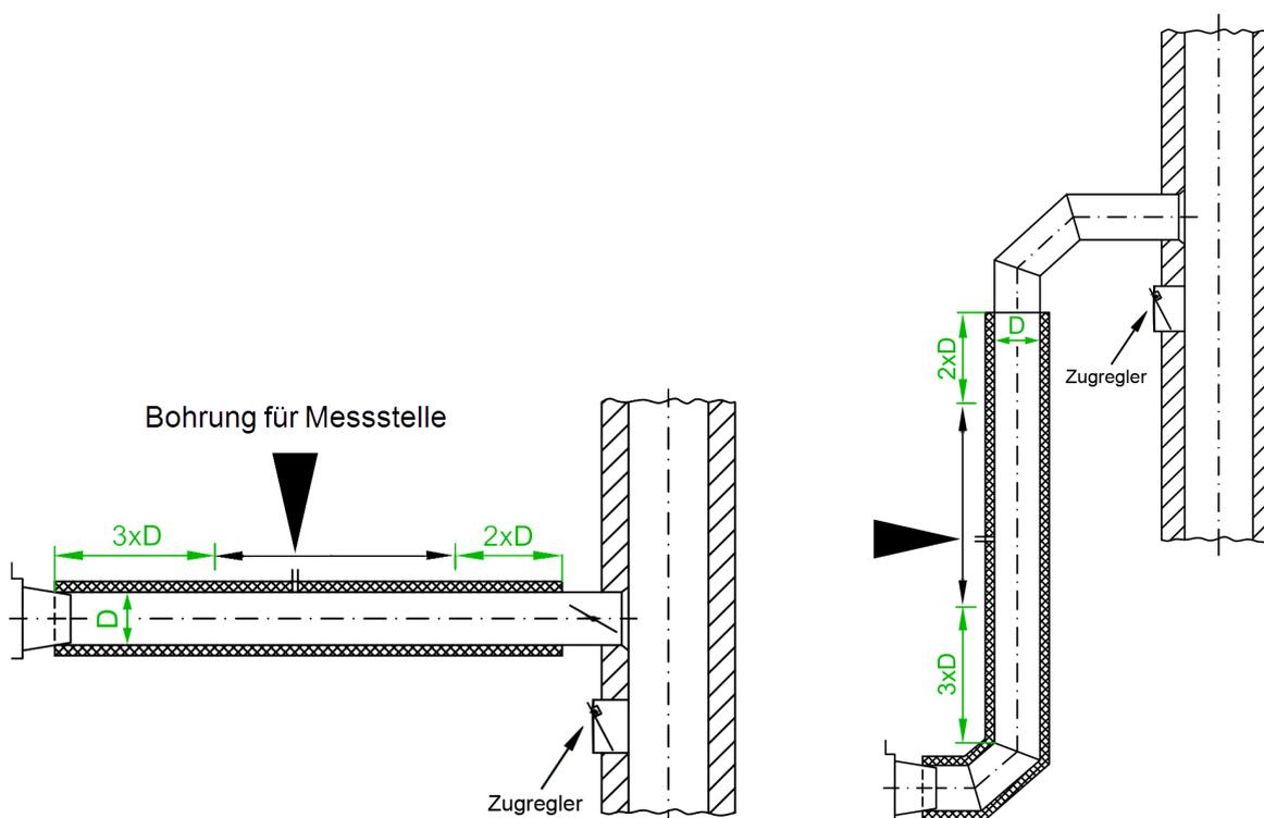
Ist die Umsetzung dieser Vorgaben nicht möglich, dann muss die Messstelle nach einer Beruhigungsstrecke, also nach dem längsten gerade laufenden Teilstück des Rohres, angebracht werden. Die Ausrichtung des Rohres spielt in diesem Fall keine Rolle.
