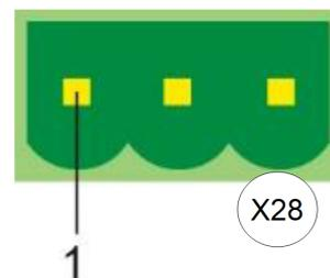
Potentialfreier Relaisausgang zum Schalten eines Fremdkessels, falls dieser die Freigabe von der SOLARFOCUS-Kesselregelung erhält.
