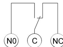
Dabei handelt es sich um einen potenzialfreien Relaisausgang zum Schalten eines Fremdkessels. Z.B. der Fremdkessel erhält eine Freigabe von der SOLARFOCUS-Regelung.
