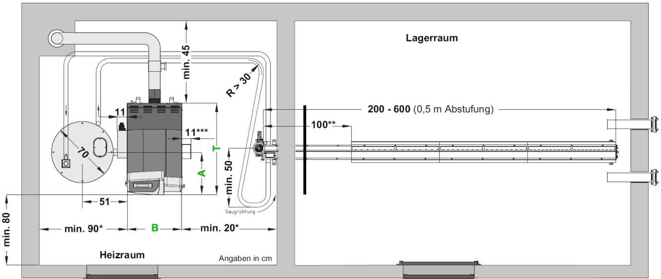
\* Die Zugänglichkeit zur Kesselrückseite muss gegeben sein. Es muss also entweder links oder rechts ein Abstand von mindestens 45 cm gewährleistet sein.
