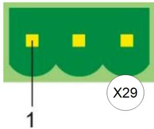
Potentialfreier Relaisausgang z.B. zum Schalten einer optischen oder akustischen Warneinrichtung. Diese löst bei einer Störungsmeldung am Kessel aus.
