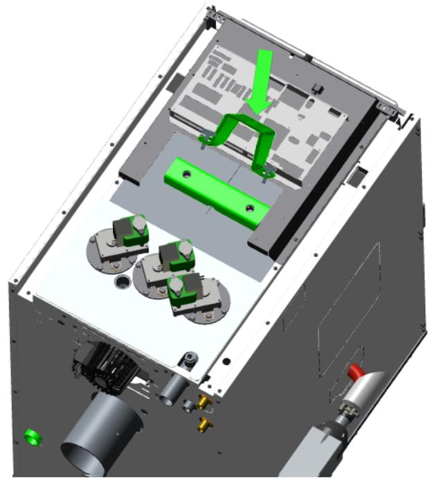
**Transporthaken** (Art. Nr. 98534): Dieser Artikel ist nicht im Lieferumfang enthalten. Er dient zum Anheben des Kessels mittels Hebezeug.
