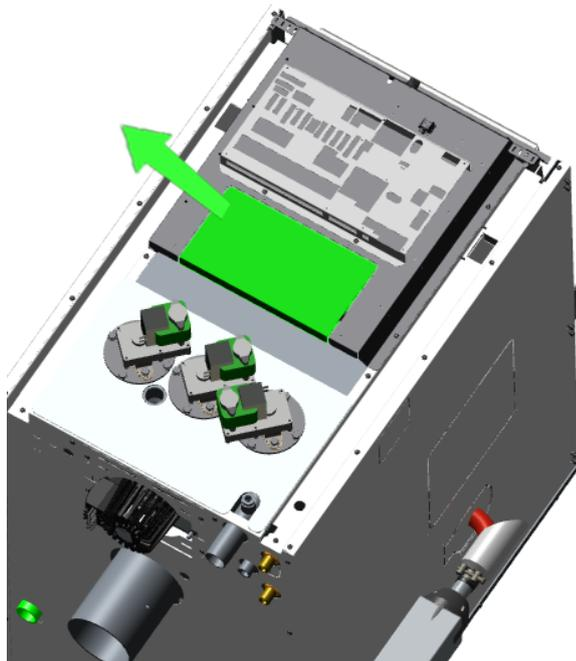
Zum Sichern des Kessels bei komplizierten Einbringsituationen kann beim **thermi<sup>n</sup>ator II 49** und 60 die Einhängelasche an den Metallkuven an der Kesselunterseite genutzt werden.
