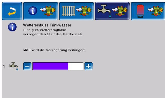
Eine gute Wetterprognose verzögert den Start der Wärmepumpe bei einer Anforderung durch den Trinkwasserspeicher/Trinkwasserbereich. Somit wird der thermischen Solaranlage die Möglichkeit und Zeit gegeben, den Speicher später aufzuladen, ohne dass die Wärmepumpe starten muss.
