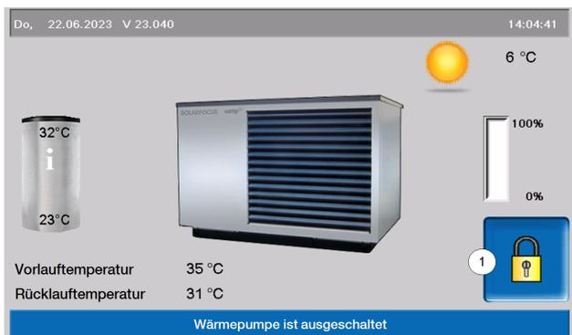
Diese Funktion dient zum Schutz vor unbefugter Änderung der Regelungsparameter. Bei aktiver Benutzersperre werden die Parameter der einzelnen Masken angezeigt, können aber nicht geändert werden. Die aktive Benutzersperre wird in den Masken durch ein Vorhängeschloss-Symbol 1 signalisiert.
