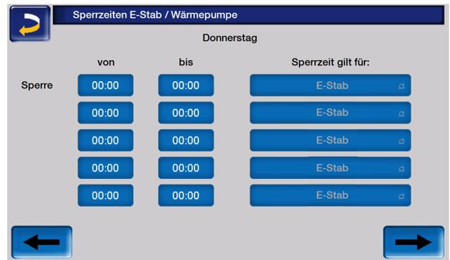
Die Sperrzeiten gelten entweder für die Wärmepumpe, oder den Elektro-Heizstab, oder beide gemeinsam.
