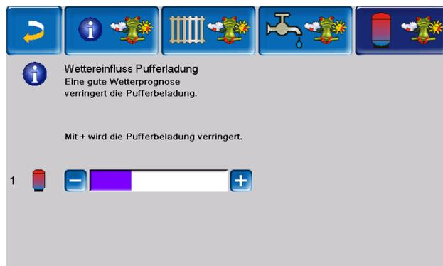
Bei guter Wetterprognose wird der Pufferspeicher innerhalb der Freigabezeit für eine kürzere Zeit beladen.
