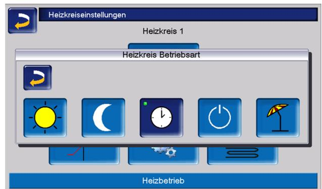
**Hinweis** - Bei Wärmepumpen sollte der Heizkreis ausschließlich im reinen Heizbetrieb ohne Absenkbetrieb laufen.
