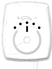
Abb. 2-29: Régler le moteur du mélangeur de cette façon
