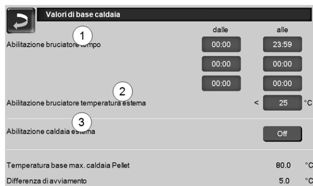
Abb. 2-11: Valori di base caldaia
